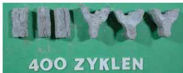
Prüfkörper Quick-Supo und Quick-Kapo nach Abschluss der Prüfung bei 400 Frost-Tausalzzyklen.
