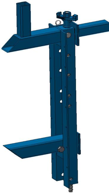
Die ASU-Zwinge kann, wie auf Seite 2 abgebildet, vertikal oder horizontal montiert werden. Zum Klemmen müssen geeignete Hölzer untergelegt werden. Achten Sie auf einen ausreichenden tragfähigen Untergrund. Zur Verwendung ist eine projektbezogene Statik erforderlich, die bauseitig beizustellen ist. Nach abgeschlossener Montage muss jede Zwinge auf einen sicheren Halt überprüft werden.
