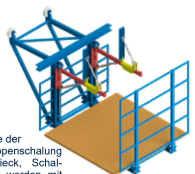
Jetzt erfolgt die Montage der Bauteile für die Kappenschalung (Kragarme, Abstützdreieck, Schalstützwand und Spindel werden mit Absteckbolzen montiert).
