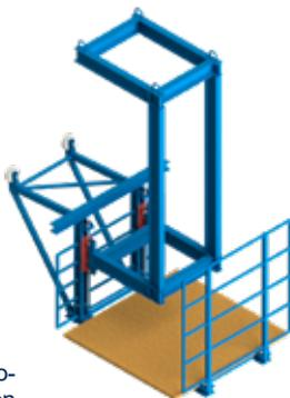
Wenn die Elemente in den Rollenkonsolen hängen, werden sie mit Schrauben zu einem Zug miteinander verbunden.
